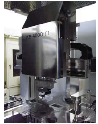
吸引、培養液、懸濁など、 それぞれに最適化された マルチチップヘッドを装備
