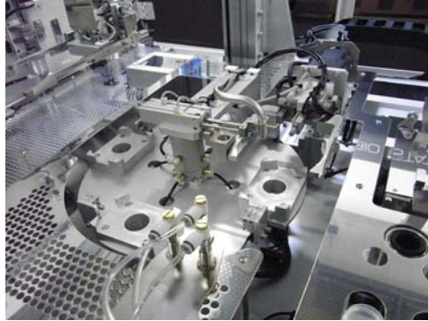
運動、タッピング機構を備えた シャーレ回転ステージ
